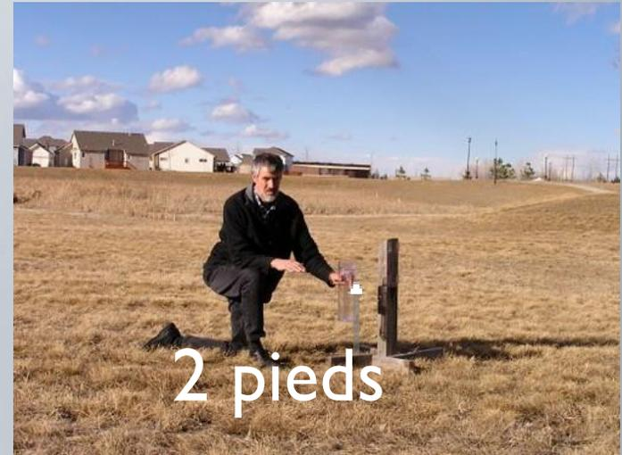
En zone développée, installez le dessus du pluviomètre approximativement à 5 pieds du sol
