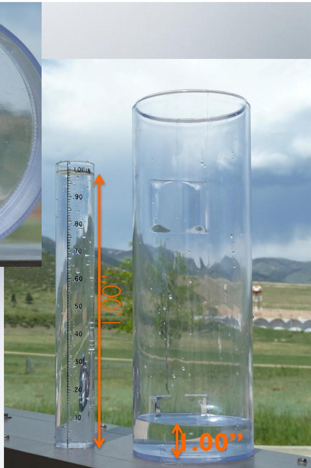
*Un pouce de pluie dans le cylindre intérieur semble différent d'un pouce de pluie dans le cylindre extérieur*
