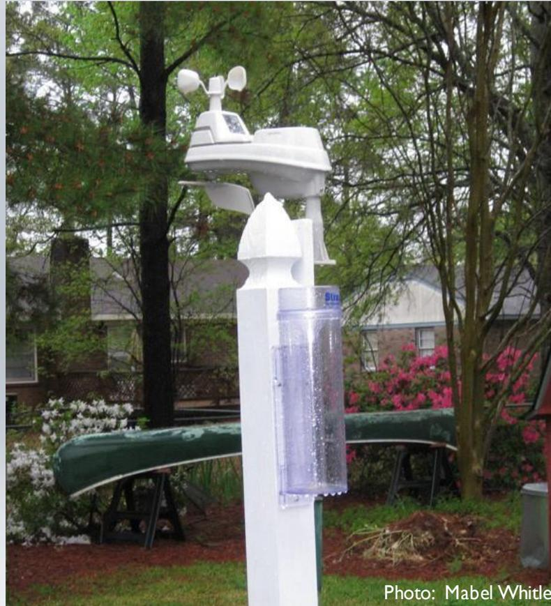
**Réponse :** Afin de comparer avec précision les rapports du CoCoRaHS, tous les observateurs doivent utiliser le pluviomètre de 4 pouces du CoCoRaHS. Les pluviomètres automatisés ont tendance à sous-estimer les fortes précipitations et ne mesurent pas avec précision le contenu en eau de la neige. Vous pouvez installer le pluviomètre de 4 pouces à côté de votre station automatisée mais transmettez ce qui a été recueilli par le pluviomètre de 4 pouces.
