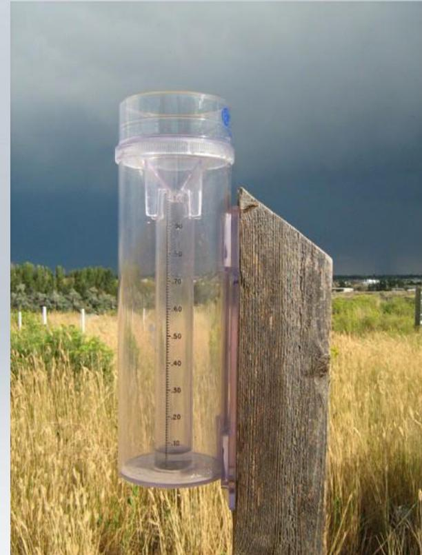
Coupez le dessus du poteau en diagonal pour réduire les éclaboussures dans le pluviomètre
