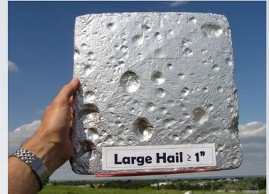
Panneau à grêlons de styromousse recouvert de papier-aluminium
